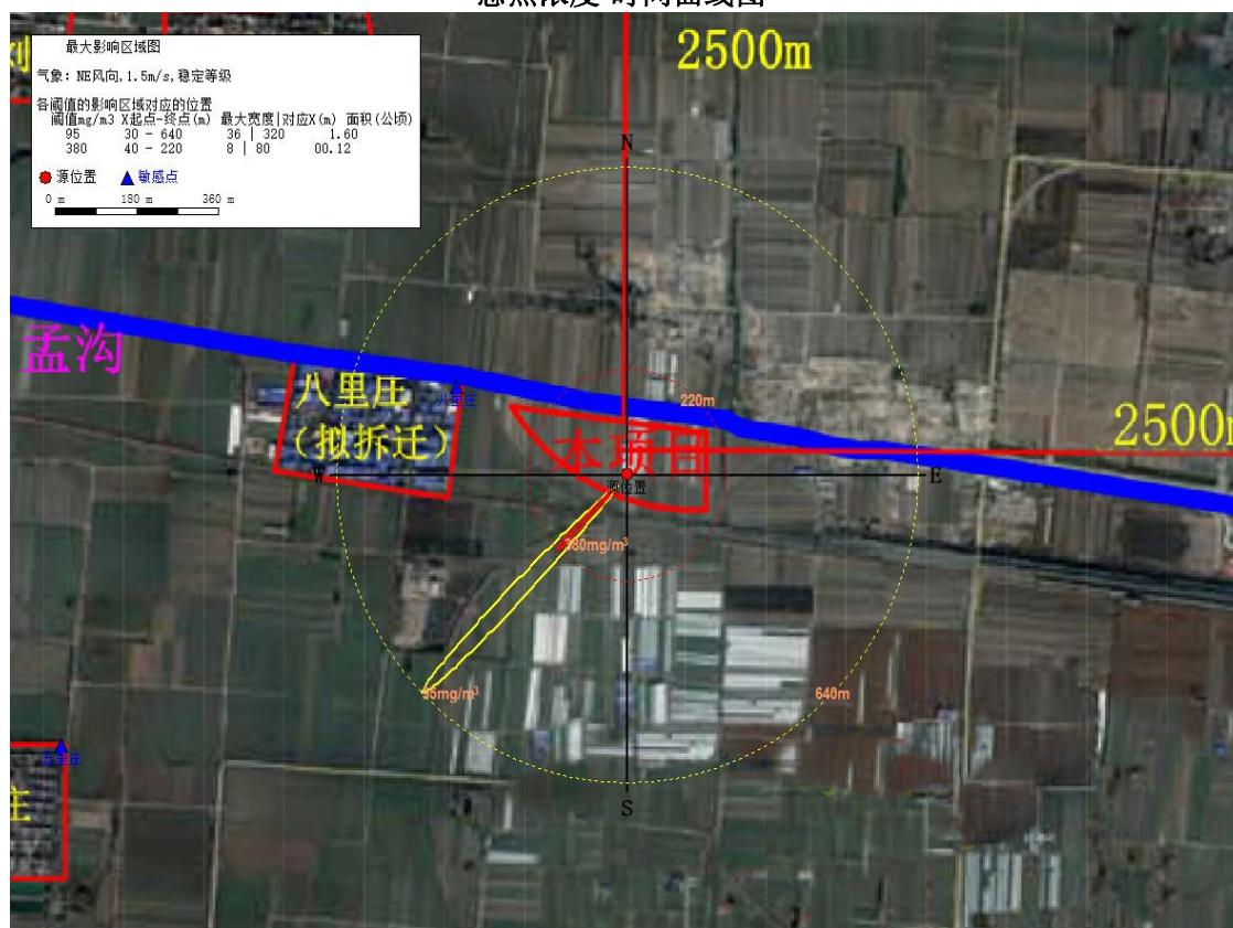
图 4.4-40 最不利气象条件下石油醚储罐泄漏引发火灾或爆炸产生伴生/次生物质 CO 超过阈值最大轮廓线图
